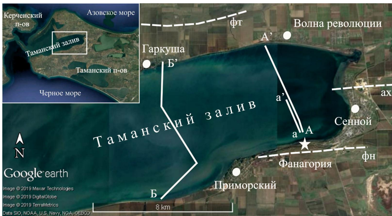
Рис. 23. Схема расположения линий профилей в акватории Таманского залива: АА' – НСП-профиль; аа' – профилографа; ВВ' – геологический. Оси антиклинальных складок. Составлена автором по [Государственная..., 2000в]. Основа: снимок Google Earth [Google..., 2018]. Обозначено: ах – Ахтанизовская, фн – Фанагорийская, фт – Фонталовская. Звездочкой отмечено местоположение древнего города Фанагория
